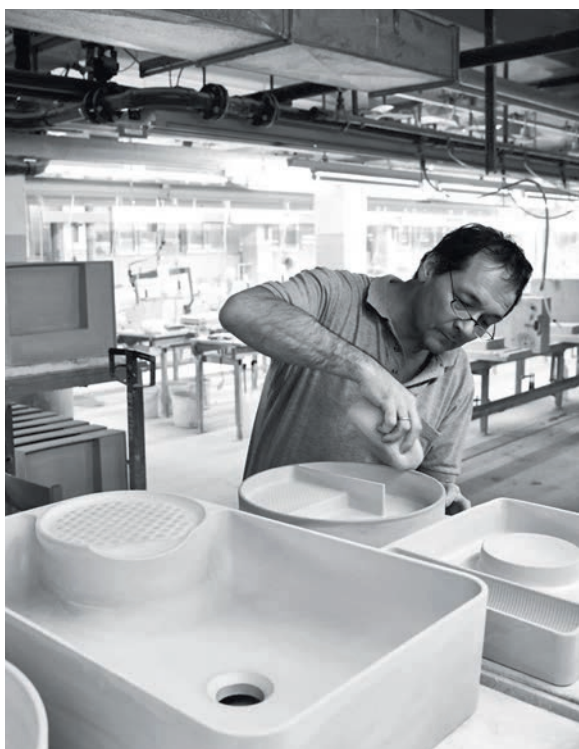
Links: Handarbeit am laufenden Band: entformen, garnieren, entgraten, putzen und schwämmen. Rechts: Struktur-Studien am eckigen Waschtisch.
