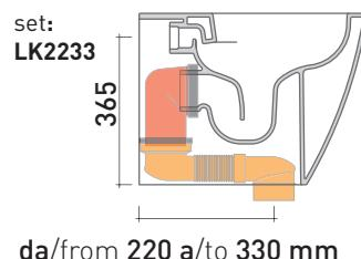
Per usare i vasi con sistema **Plus** occorre misurare la distanza dal muro al centro dello scarico dell'impianto esistente. Per poi ordinare il modello di vaso scelto e l'articolo del set di scarico adatto alla misura rilevata.
