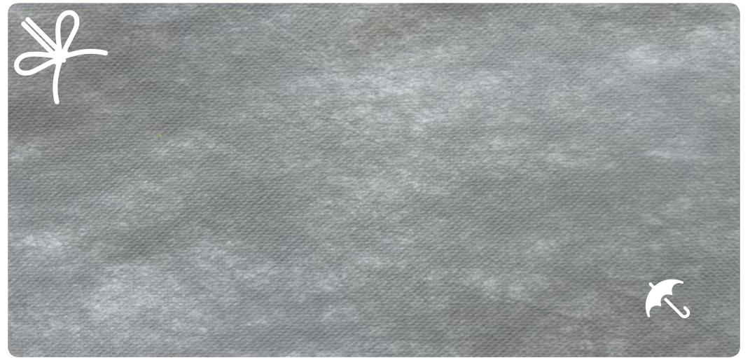
Realizzato con un accoppiato in 3 strati. I due strati esterni sono di propilene ed hanno funzione sia estetica, sia di protezione della membrana interna. La membrana interna è il tessuto tecnico che svolge la maggior parte del lavoro e che ha le proprietà di permeabilità all'aria e impermeabilità. Lavaggio: acqua e sapone, no lavaggio a macchina o a secco.
