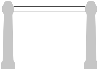
Tubo 9522.842 • Accessorio per transenna al metro lineare • Acciaio zincato a caldo e verniciato • Ø 42mm x 3mm di spessore
