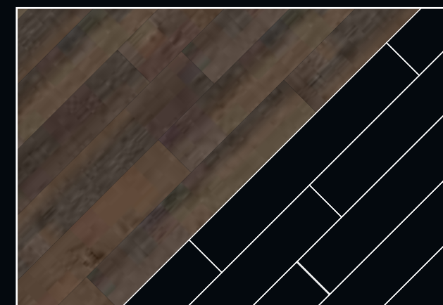
Diagonale Verlegung Diagonal lay
