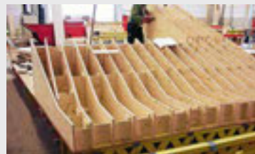
Realizzazione dei moduli di cassaforma 3D nel reparto assemblaggi di PERI, a partire da componenti standard VARIO.
