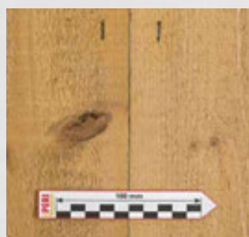
Esempio di fissaggio con graffette
