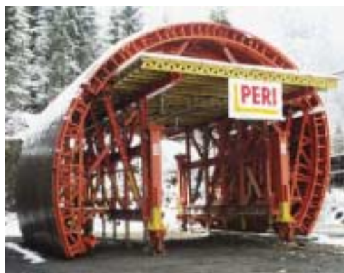
Cassaforma metallica su carro a portale semovente. La messa in opera e il disarmo sono effettuati con un meccanismo idraulico.
