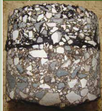
Figura 1 - Risultati sperimentali – valori medi (in foto un provino con strato inferiore stabilizzato)
