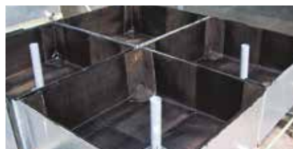
2. Vasche di prova impermeabilizzate
