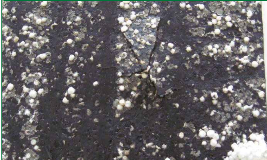
FACCIA INFERIORE CON ROTTURA A "STELLA"
