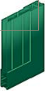
Doghe verticali Tamponamento oscurante realizzato con doghe in resina polimerica disposte verticalmente con interasse di 55 mm.
