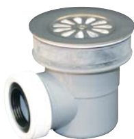
Piletta godet "europa" PP, griglia amovibile Ø 80 inox, uscita laterale, dado e guarnizione
