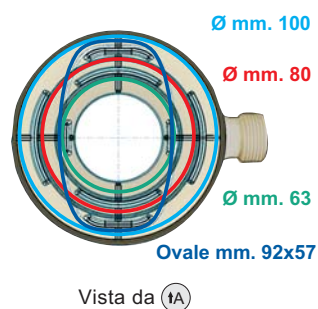
INNESTO DEL TUBO PLUVIALE INFERIORE
