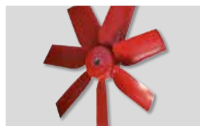
Ventola antiaderente Equilibratura dinamica Secondo la norma ISO 1940, per ridurre il rumore ed evitare le vibrazioni. Protetta con vernice antiaderente per evitare depositi di sporcizia sulle pale.
