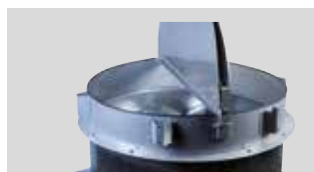
Serranda antiritorno Per prevenire l'ingresso di aria o acqua a ventilatore spento.
