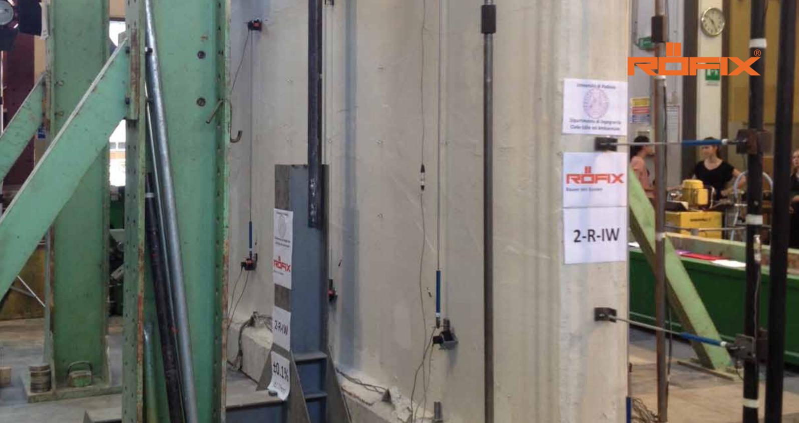
RÖFIX dopo una importante ricerca in collaborazione con il laboratorio tedesco Karlsruher Institut für Technologie (KIT), ha messo a punto un sistema di rinforzo armato basato sull'impiego di una speciale rete quadriassiale, in fibra di vetro ibrida e una malta minerale appositamente studiato allo scopo di migliorare il comportamento sismico della muratura e di garantire un elevato livello di sicurezza.
