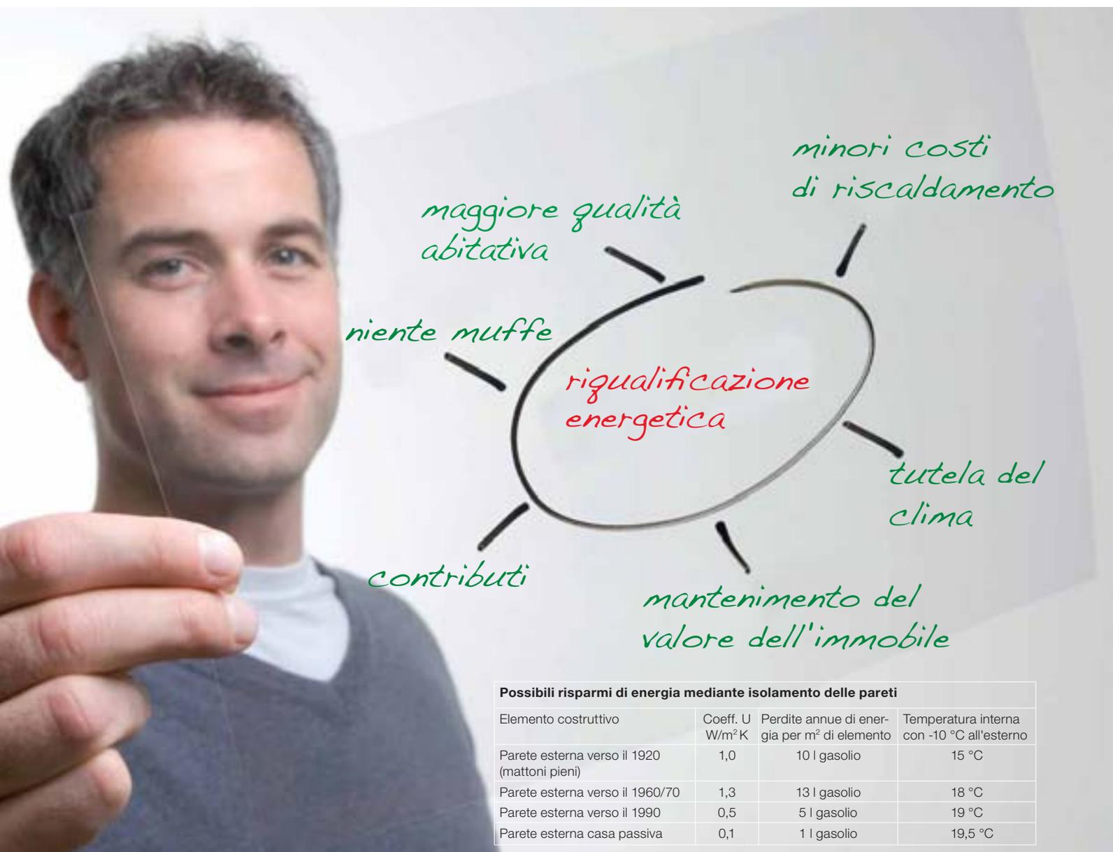
**Possibili risparmi di energia mediante isolamento delle pareti**
