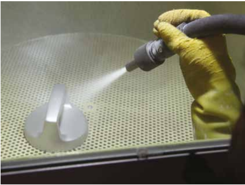
IMPIANTO DI PALLINATURA CON SFERE DI CERAMICA SHOT-PEENING PLANT WITH CERAMIC BALLS INSTALLATION DE GRENAILLAGE AVEC BILLES EN CÉRAMIQUE INSTALACIÓN DE GRANALLADO CON BOLAS DE CERÁMICA
