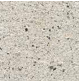
superficie tratada con chorro de arena de granito
