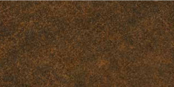
3. Aspect/teinte du produit en corten oxydé, 12/18 mois environ après la date d'installation.
