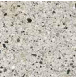
Surface polie avec des agréats de granit
