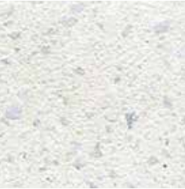
superficie tratada con shorro de arena con granilla de marmol blanco
