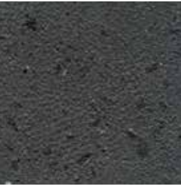
superficie tratada con chorro de arena con granilla de marmol negro
