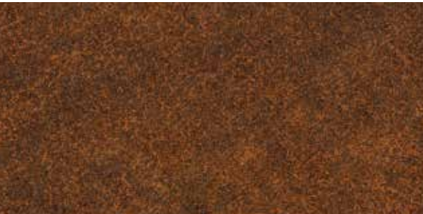
2. Aspecto/Tonalidad del acero corten despues de 4/6 meses desde la instalación.
