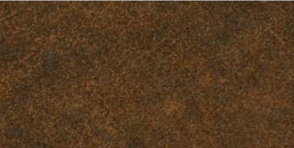
3. Aspetto/tonalità del manufatto al termine del periodo di ossidazione dopo circa 12/18 mesi dall'installazione.
