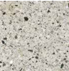
Surface polie avec des agréats de granit
