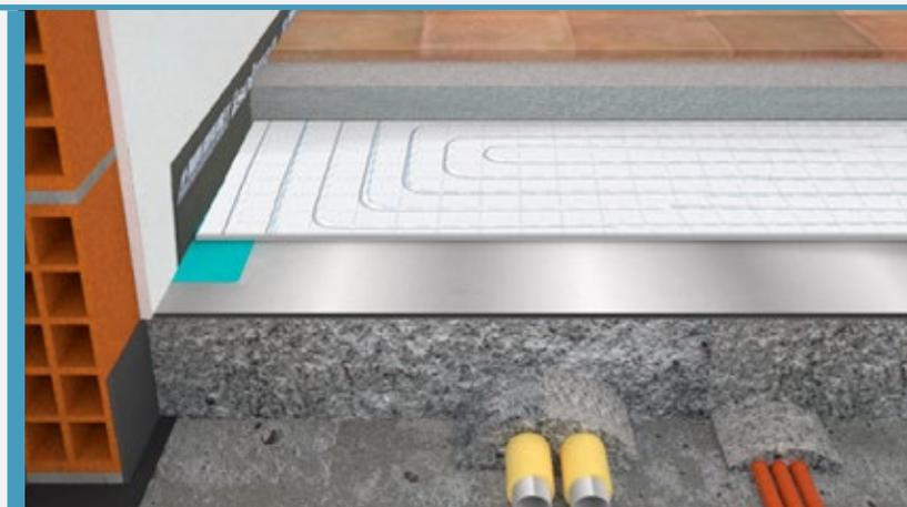
STRUTTURA CON RISCALDAMENTO
