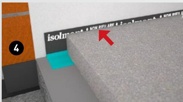
**4** **Realizzazione del massetto:** il sistema materassino Isolmant + Fascia Perimetrale Isolmant realizza una perfetta vasca a tenuta all'interno della quale il massetto cementizio potrà "galleggiare" senza stabilire alcuna connessione rigida con gli elementi della struttura. È importante che non rimangano punti scoperti: nel caso ce ne fossero vanno rivestiti con ritagli di materiale elastico. La fascia deve eccedere di alcuni cm l'altezza del pavimento finito.
