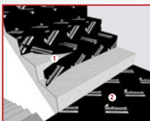
**1.** IsolTile viene già fornito in teli per alzata e pedata dei gradini. Rifilare i teli di IsolTile e incollarli con colla cementizia di classe C2.
