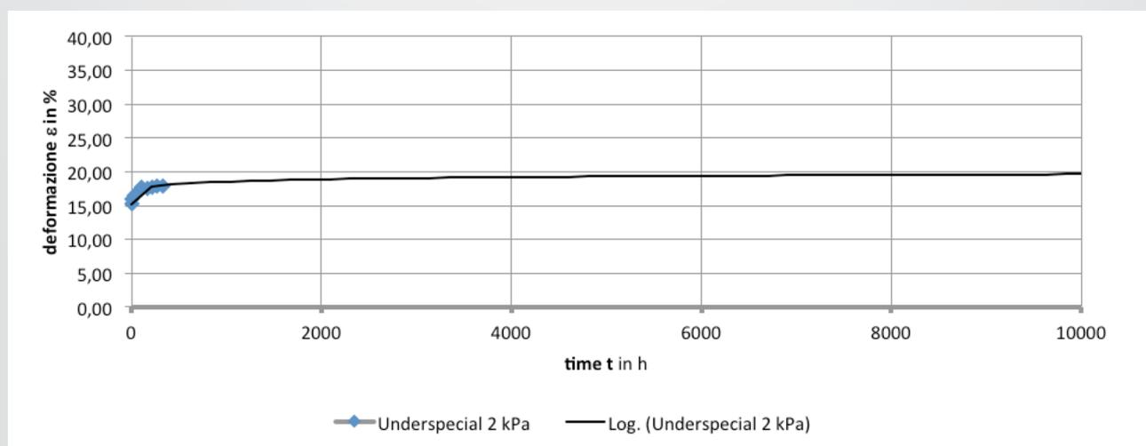
Comportamento allo scorrimento viscoso a lungo termine Isolmant UnderSpecial, Isolmant UnderPlus Black.E, Isolmant Radiante e Isolmant BiPlus
