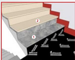
**1 e 2.** Posare uno strato di malta di allettamento sulla superficie di IsolTile già posato e procedere alla posa del marmo.
