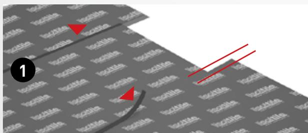
**1** **Continuità dei teli:** i vari teli di materiale resistente devono costituire uno strato uniforme e continuo; per facilitare tale operazione alcuni prodotti sono dotati di battentatura, i singoli teli devono comunque essere accostati e sigillati attraverso apposito nastro adesivo.
