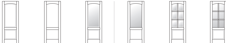
cieca con bugna blank with raised panel cieca con foderina blank with flat panel finestrata con bugna glazed with raised panel finestrata con foderina glazed with flat panel finestrata inglese con bugna glazed English with flat panel finestrata inglese con foderina glazed English with flat panel
