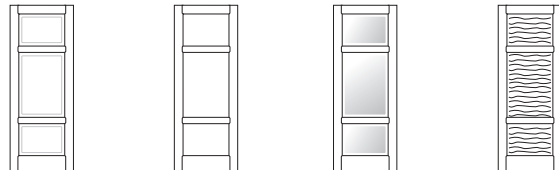
cieca con bugna blank with raised panel cieca con foderina blank with flat panel finestrata glazed cieca con foderina venature oriz. blank with horizontal grain flat panel
