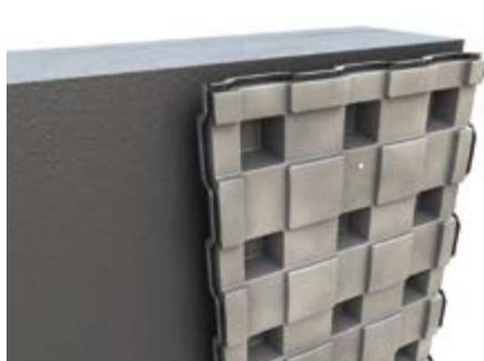
In prossimità del cordolo del solaio, fissare il pannello più alto con un tassello (preferibilmente chimico e non meccanico).
