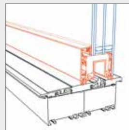
FIN-Slide Slim-line Cristal alluminio-PVC, disponibile anche in alluminio, legno o ForRes all'interno. Oppure in esecuzione Slim-line alluminio-legno o alluminio-ForRes
