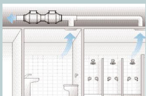
ventilatori in serie per incrementare la pressione statica utile
