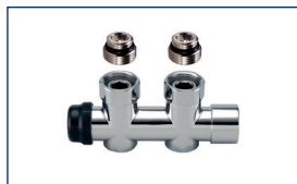
TO 101 Valvola H termostattizzabile bitubo per alimentazione a pavimento con prerogolazione con attacco femmina Válvula H termostatizable bitubo para alimentación en suelo con prerregulación con conexión hembra
