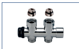
TO 103 Valvola H termostattizzabile bitubo per alimentazione a pavimento con prerogolazione con attacco maschio Válvula H termostatizable bitubo para alimentación en suelo con prerregulación con conexión macho
