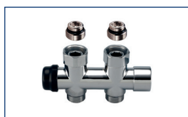
TO 103 B Valvola H termostattizzabile mono/bitubo (con bypass regolabile 50-100%) per alimentazione a pavimento con prerogolazione con attacco maschio Válvula H termostatizable mono/bitubo (con bypass ajustable 50-100%) para alimentación en suelo con prerregulación con conexión macho
