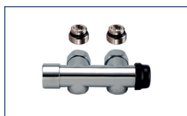
TO 102 B Valvola H termostattizzabile mono/bitubo (con bypass regolabile 50-100%) per alimentazione a parete con prerogolazione con attacco femmina Válvula H termostatizable mono/bitubo (con bypass ajustable 50-100%) para alimentación en pared con prerregulación con conexión hembra
