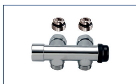
TO 104 B Valvola H termostattizzabile mono/bitubo (con bypass regolabile 50-100%) per alimentazione a parete con prerogolazione con attacco maschio Válvula H termostatizable mono/bitubo (con bypass ajustable 50-100%) para alimentación en pared con prerregulación con conexión macho
