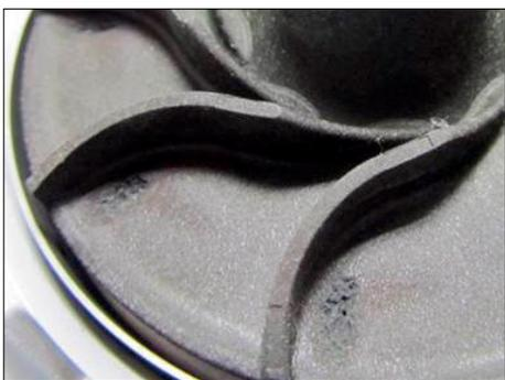
Per evitare tale pericolo è necessario garantire un valore minimo di pressione all'ingresso della pompa: valore individuato da un apposito indice: l'**NPSH** (*Net Positive Suction Head*) che dipende dal tipo di pompa e dalle condizioni di funzionamento, e soprattutto dalla temperatura del fluido e dalla pressione atmosferica.
