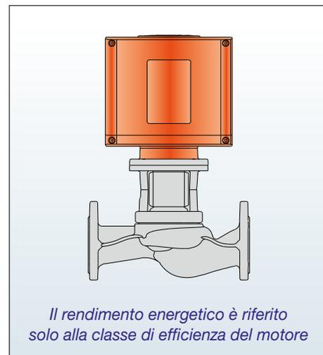
In particolare, le direttive europee hanno stabilito che dal 1° gennaio 2017: *“i motori elettrici delle pompe a motore ventilato con potenza nominale compresa fra 0,75 e 375 kW devono corrispondere alla classe energetica IE3 oppure alla classe IE2 ed essere equipaggiati di un dispositivo di regolazione della velocità di rotazione”.*
