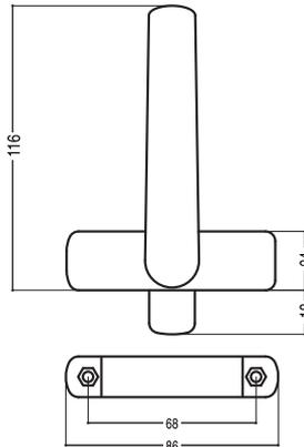
Il Tavellino si applica su qualsiasi tipologia di profilo per infissi ad apertura interna o esterna. Si dimostra un accessorio versatile, grazie agli spessori in dotazione da mm. 3 - 4 - 5 e alla maniglia, che può essere posizionata secondo la necessità a destra, a sinistra o centrale ( Fig. 1 ).
