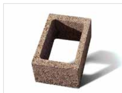
Blocco pilastro parete da 33 cm sezione cls 25x38 cm *38 cm sezione cls 30x38 cm **44 cm sezione cls 33x39 cm *Possibilità di inserire isolante da 5 cm **Possibilità di inserire isolante da 8 cm
