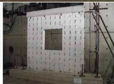
Sopra: Prova sismica su parete ISOTEX piena A sinistra: Prova sismica su parete ISOTEX di due piani A destra: Prova sismica su parete ISOTEX con finestra
