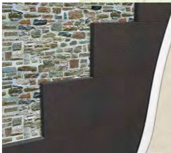
Isolamento a cappotto su parete in pietra
