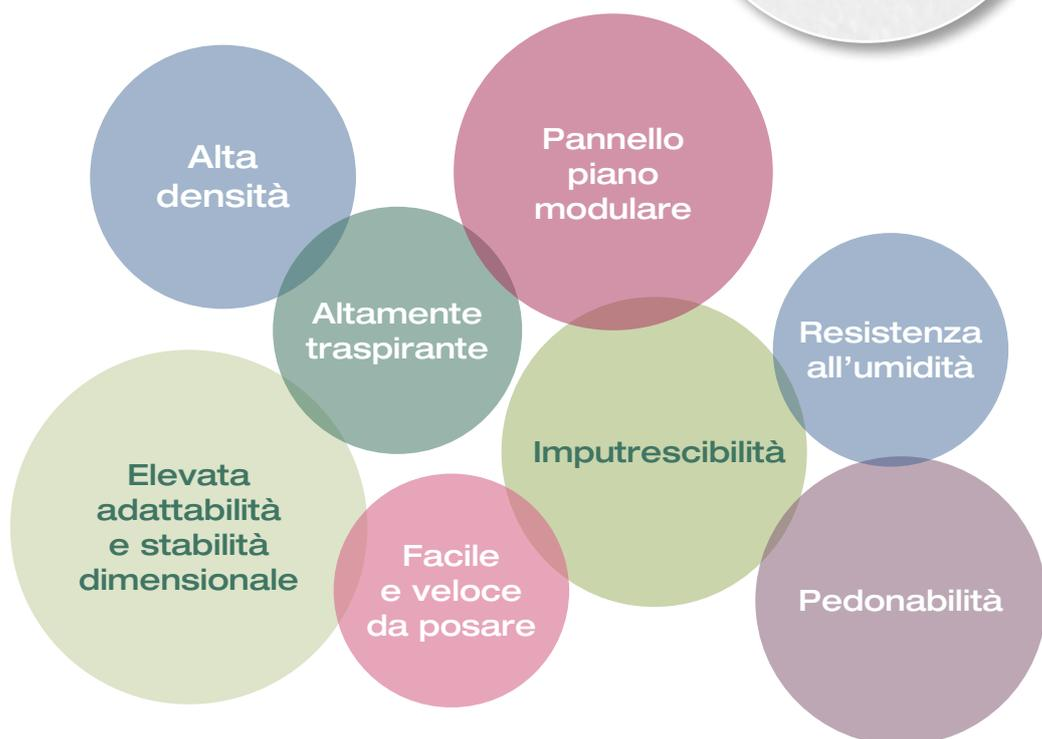
È un pannello isolante realizzato in polistirene espanso sinterizzato ad alte prestazioni meccaniche di compressione e di pedonabilità, che offre il vantaggio di ottimizzare i costi di costruzione, grazie alla facilità e velocità di posa, che garantiscono all'installatore minimi dispendi di tempo nel montaggio.
