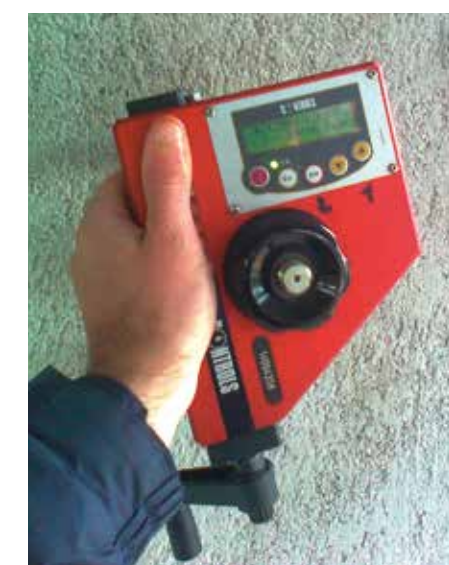
Valutazione dell'intonaco in base al risultato del test di pull-off
