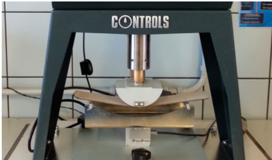
Macchina per la misurazione della deformabilità degli adesivi cementizi
