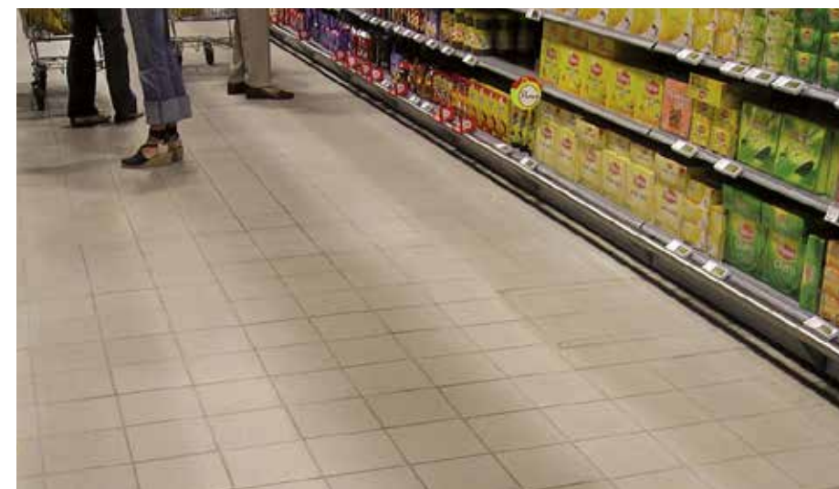
Pavimentazione di un supermercato sottoposta a elevate sollecitazioni legate al continuo passaggio di carichi concentrati che necessita di posa a letto pieno
