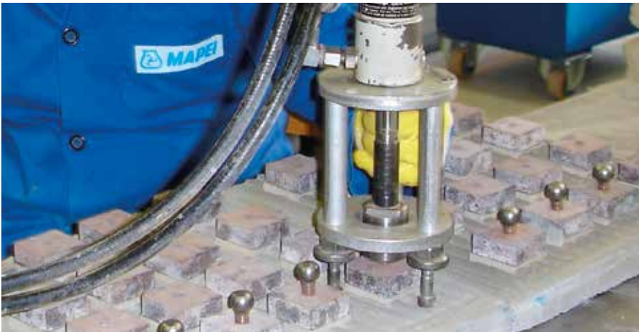
Prove di pull out per adesivi
