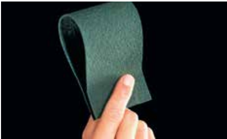
Esempio di deformabilità di un campione di MAPELASTIC
