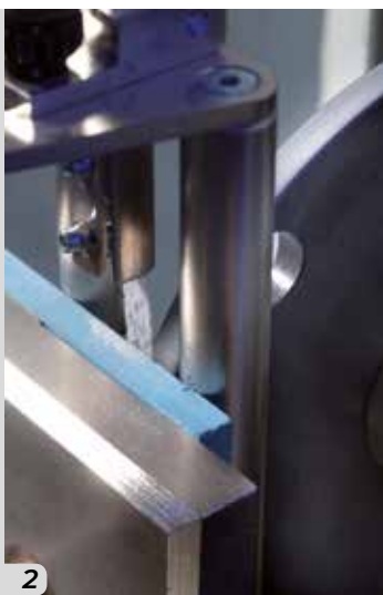
Fig. 3 - Verifica della stabilità dimensionale di un campione di fuga cementizia
