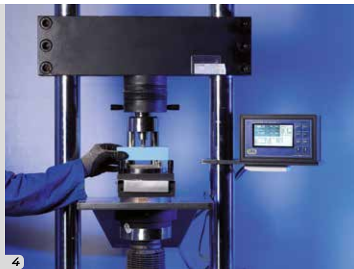
Fig. 4 - Prova di resistenza a flessione di un campione di fuga cementizia
