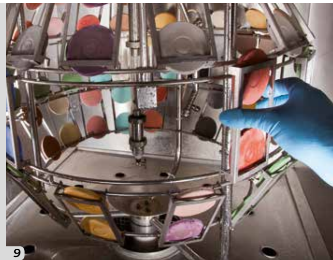
Fig. 9 - Test di invecchiamento accelerato con veterometro Fig. 10_11 - Verifica del colore mediante impiego di spettrofotometro
