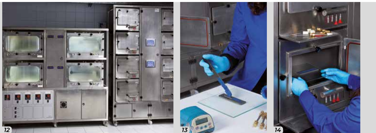
Fig. 12 - Camere ambientali disponibili c/o il laboratorio R&S Mapei Fig. 13_14 - Test di valutazione dei VOC
