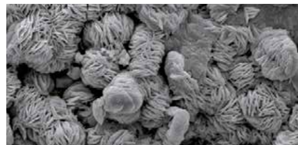
Fig. 8 - Analisi al microscopio elettronico di fuga soggetta a efflorescenze
