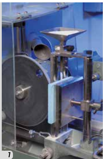
Fig. 1.2 - Test di valutazione della resistenza all'abrasione
