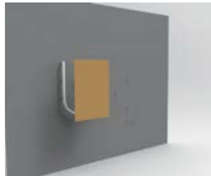
9. Rimozione del supporto in cartone.
