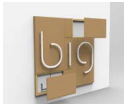
6. Completamento del tamponamento con pannelli in dotazione.
