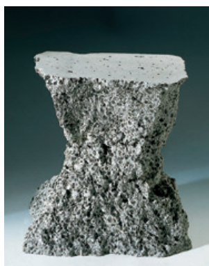
Calcestruzzi strutturali con argilla espansa Leca.
