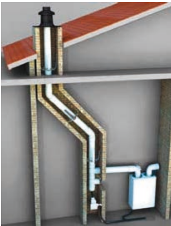
Condotto interamente rigido con sifone condensa.
