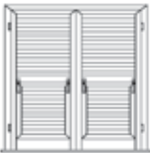
TRAVERSO AGGIUNTIVO SULL'ANTA ADDITIONAL CROSSPIECE ON THE LEAF
