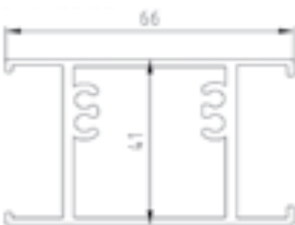
MONTANTE ROMPIRATTO SU PERSIANA SM / SA SHUTTERING UPRIGHT ON SM / SA SHUTTER
