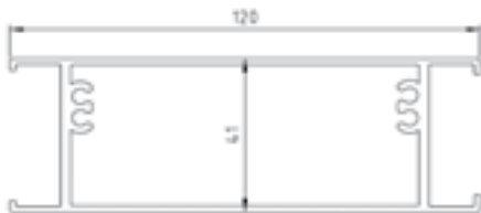
TRAVERSO AGGIUNTIVO SULL'ANTA ADDITIONAL CROSSPIECE ON THE LEAF
