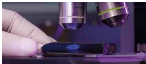
SPESSORE - Microscopio fluorescenza ingrandimento 20X. Normativa UNI EN 1849-1
