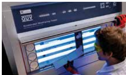
INVECCHIAMENTO UV - QUV camera di invecchiamento raggi UV. Normativa UNI EN 1297 (ciclo da 3000 ore)
