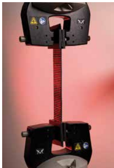
TRAZIONI - Dinamometro a doppia colonna con cella da 5kN. Normativa UNI EN 12311-1
