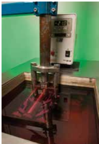
FLESSIBILITÀ A FREDDO - Termocriostato (con piegatrice). Normativa UNI EN 1109
