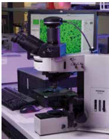
DISPERSIONI - Microscopio a fluorescenza ingrandimento 250X.
