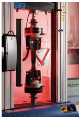
PEELING DELLE GIUNZIONI - Dinamometro. Normativa UNI EN 12316-1
