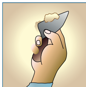
Operazioni di trattamento del giunto
