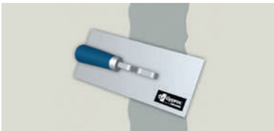
Copertura del nastro d'armatura (2ª mano)
