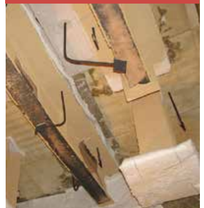
Elementi dopo la prova al fuoco
