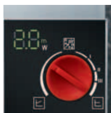
Indicatore LED per impostazione del valore nominale e indicazione della potenza.
