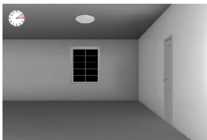
In assenza di persone, l'apparecchio si spegne, dopo un intervallo temporale impostato dall'utente (in fase di installazione dell'accessorio). When people are away, the luminaire switches off, after a set up time (value to set up during the installation of the device).
