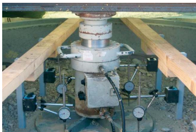
Cilindro idraulico e piastra di carico con centesimali comparatori
