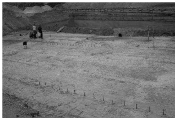
FIG. 16: TEST IN SITU CON PUNTI DI RILEVAZIONE DELLE VIBRAZIONI
