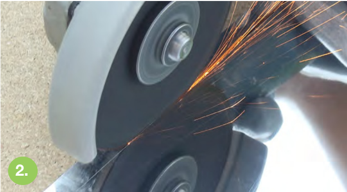
Tagliare a misura e/o eseguire angoli se necessario (vedere apposita sezione) Cut to size and/or make angles if necessary (see appropriate section)
