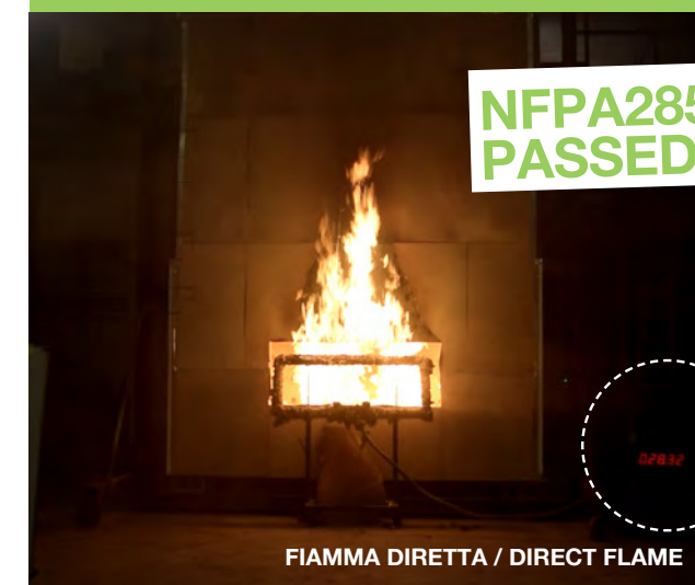
Simulazione facciata con Gammastone Air Gammastone Air Wall Assembly
