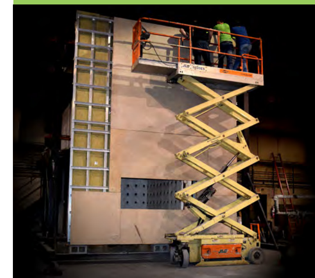
Montaggio pannelli Gammastone Air su struttura Gammastone Air test wall under construction
