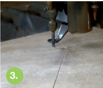
TAGLIO CON MACCHINA A IDROGETTO / CUTTING WITH WATER-JET MACHINE
