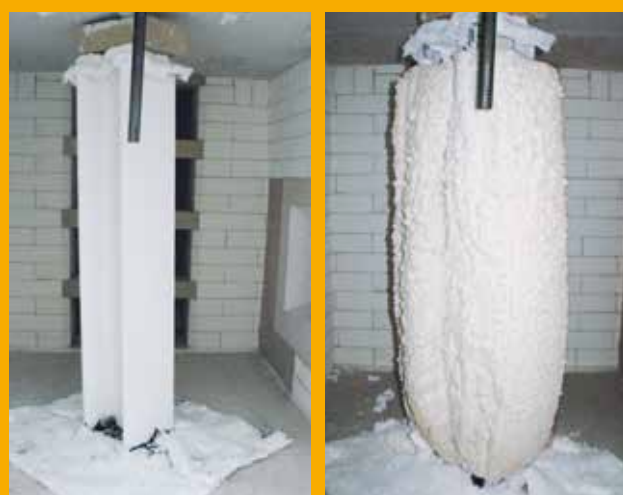
Campione rivestito (figura a sinistra) e dopo un incendio (figura a destra) / Test specimen coated (left figure) and after fire (right figure)
