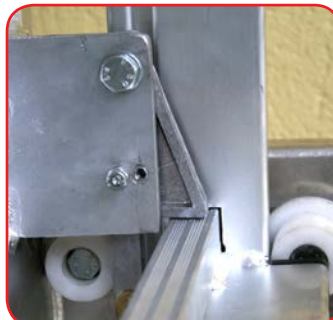
Gancio automatico sostegno piattaforma
