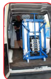
Sistema di carico su automezzo con slitta e barra di ribaltamento
